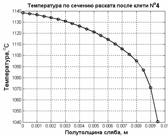
Рис. 2. Распределение температуры по сечению раската за клетью № 3
